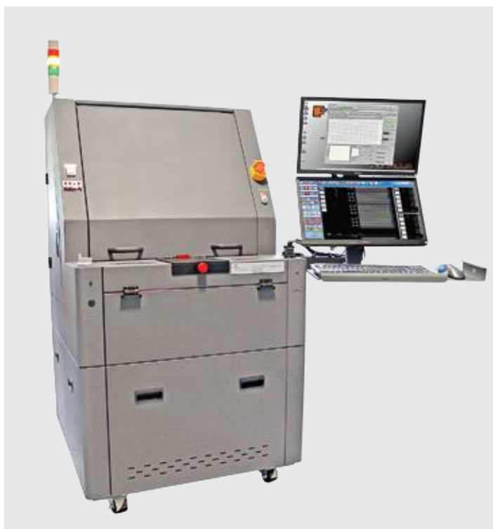
Автоматическая зондовая станция для параметрического контроля параметров устройств на пластине
