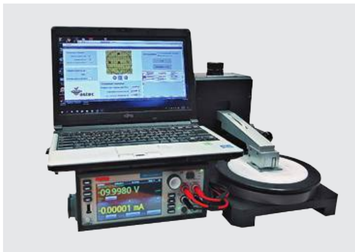
Четырёхзондовая установка для измерения удельного и поверхностного сопротивления ИУС-7
