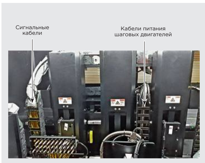
5 Пример раздельной прокладки линий питания двигателей и сигнальной линии
