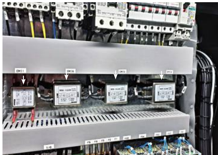
Размещение фильтров (указаны стрелками) электропитания внутри автоматической зондовой станции
