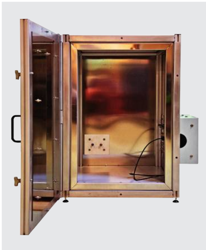
7 Камера для экранирования постоянного магнитного поля земли
