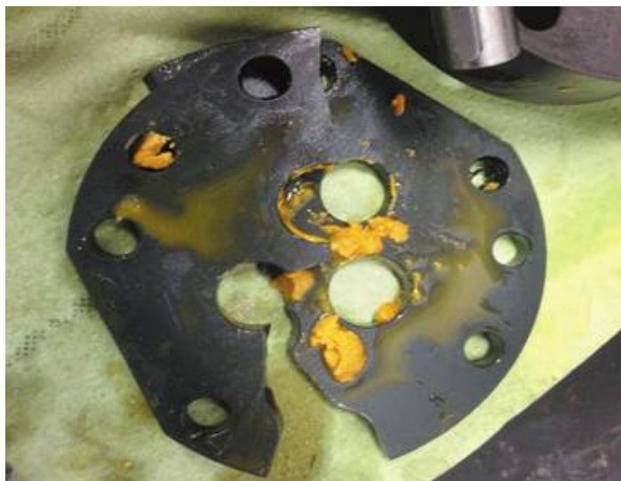
Сломанная деталь насоса. Наполнитель заблокировал насос, в результате чего каленая стальная пластина корпуса лопнула
