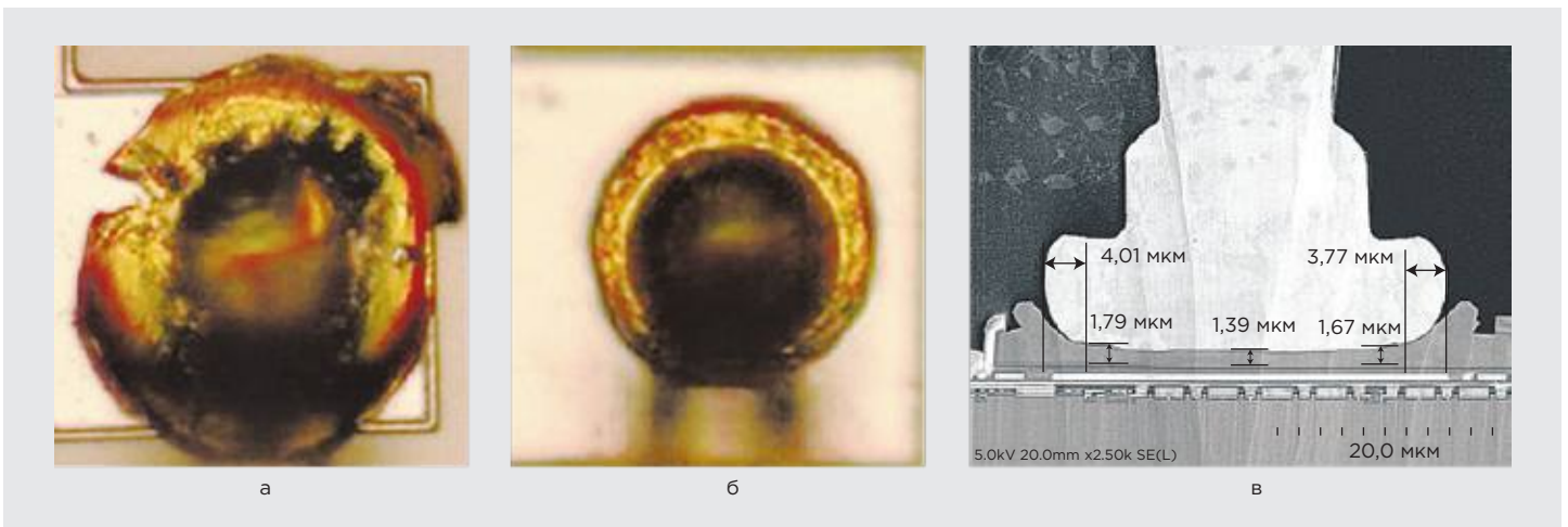
5 Сжатие Al контактной площадки: сильное, без контроля (а); качественное соединение без сильного сжатия площадки с применением системы автоматического контроля (б); граница раздела между материалами при качественном шариковом соединении, медная проволока диаметром 15 мкм (в)
