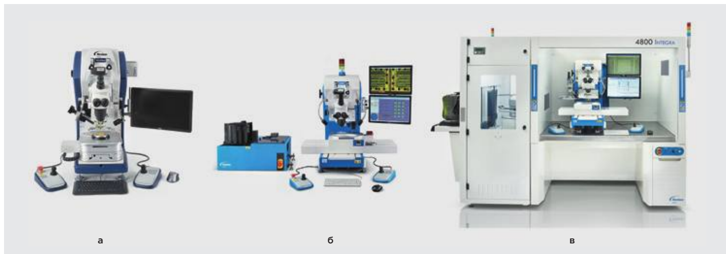
7 Варианты конструкций систем Dage: полуавтоматическая (а), автоматическая (б), автоматическая в корпусе с дверцами, включая блок фильтров и ионизаторы для работы в чистых помещениях (в)
