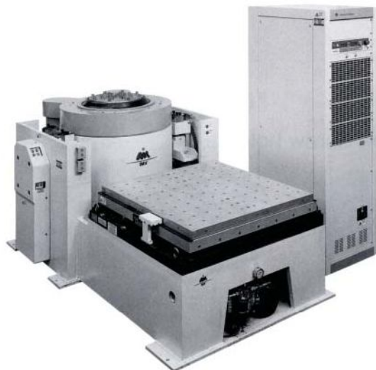
Рис. 2. Электродинамическая установка нового поколения серии «i». Установка обеспечивает проведение непрерывных испытаний в течение 8 500 часов (1 год). Данной установке принадлежал рекорд по самому большому выталкивающему усилию для установок с воздушным охлаждением
