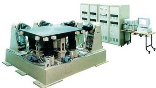
Рис. 9. Электродинамическая установка пространственной вибрации: 6 степеней свободы по механическим воздействиям. Размах виброперемещений 200 мм пик-пик
