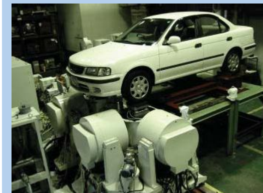
Рис. 5. Четырехопорная установка для проведения длительных испытаний подвески транспортных средств. Продолжительность испытаний до 6000 часов. Количество актюаторов от 8 до 12. Система управления позволяет подавать на вход запись механического профиля вибрации и ударов при движении транспортного средства
