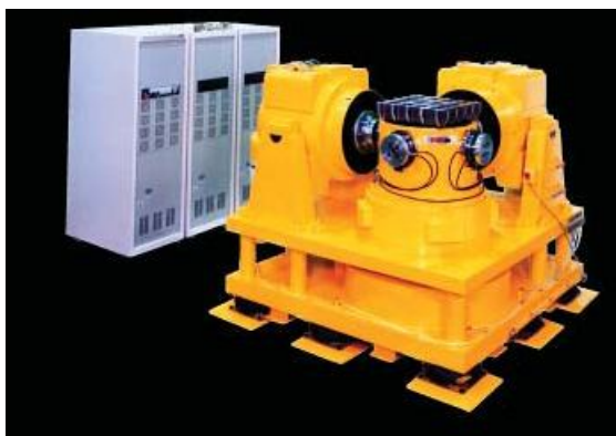
Рис. 1. Трехкоординатная электродинамическая испытательная установка. Согласование механических воздействий по разным направлениям осуществляется в специальном запатентованном устройстве, обладающим уникальными характеристиками
