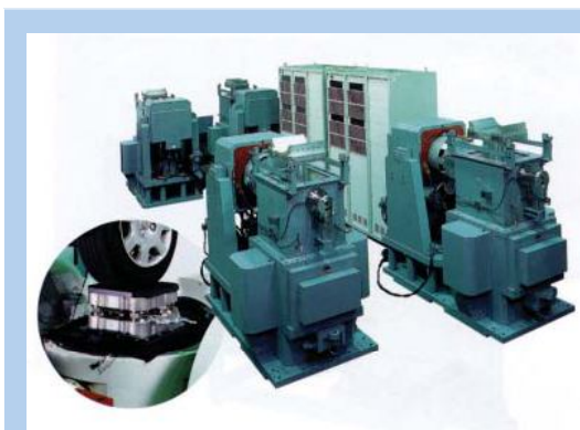
Рис. 2. Электродинамическая установка нового поколения серии «i». Установка обеспечивает проведение непрерывных испытаний в течение 8 500 часов (1 год). Данной установке принадлежал рекорд по самому большому выталкивающему усилию для установок с воздушным охлаждением
