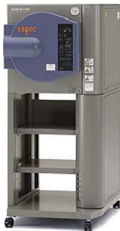
Рис. 1. Камера HAST Espac (Tabai) EHS-211
