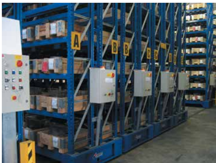
15 Система мобильных оснований для стеллажного палетного хранения
