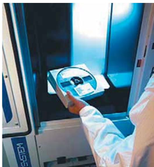
6 Загрузка компонентов в систему ACS 2000
