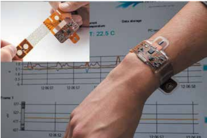
Выполненный по гибридной технологии браслет, измеряющий температуру, влажность, движение и сердечную активность пациента. Источник: Хольст Центр
