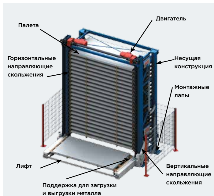
12 Структура системы для хранения листового металла
