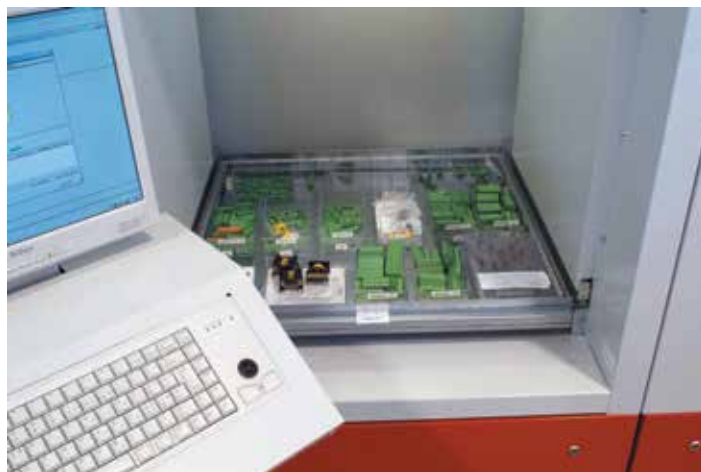
11 Лоток ICAM: Silo2 для хранения отдельной группы товаров
