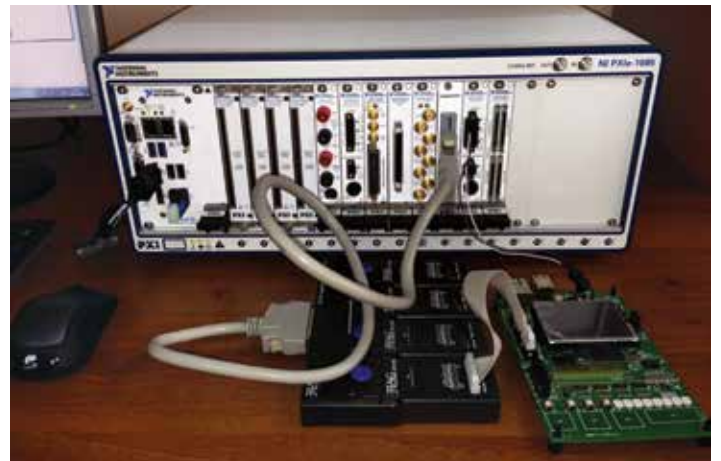
6 Интегрированное решение, объединяющее функциональный тестер с контроллером периферийного сканирования
