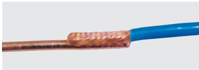
6 Сращивание проводов (splice) методов ультразвуковой сварки
