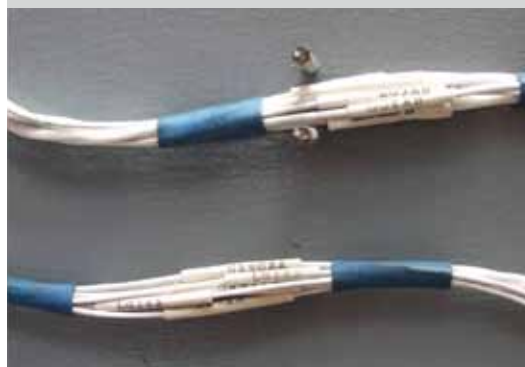
Рис. 3 Маркировка проводов в жгуте – устаревшие методы маркировки значительно повышают трудоемкость операции сборки жгута, увеличивают его линейные размеры и вес, не обеспечивая гарантированной идентификации в течение срока службы оборудования
