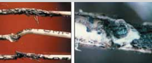
Рис. 5 Дефекты маркировки проводников в жгуте проводов – недопустимое утонение изоляции проводников при их эксплуатации в составе жгута приводит к возникновению короткого замыкания и выходу оборудования из строя
