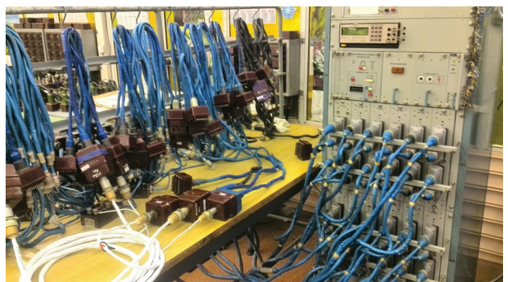
6 Технологические кабели для соединения системы типа КУСТ (1975г. выпуска) и АСК
