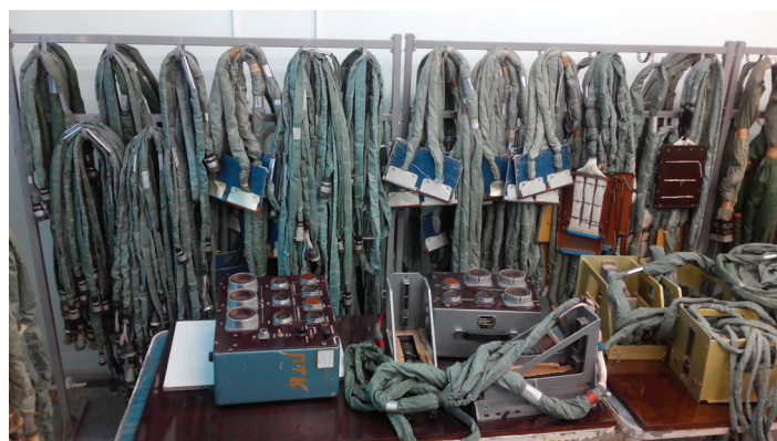
2 Технологические кабели для соединения тестера и проверяемого изделия
