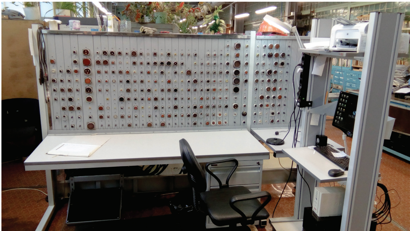
7 Универсальное рабочее место контроля УЛЕЙ для проверки 270 различных типов жгутов
