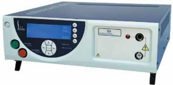
**8** Прибор для измерения сопротивления изоляции и испытания на пробой
