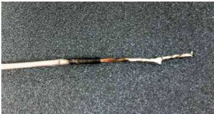
10 Зачистка, подкрутка и лужение провода МГТФ (0,12 кв. мм): слева — вручную; справа — на автоматической линии
