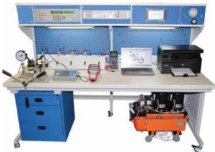
2 Типовое рабочее место по ремонту и регулировке средств измерения давления
