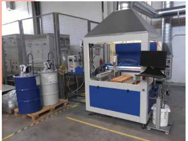
8 Пусконаладочные работы оборудования Fisnar Liquid Control для нанесения силиконовых материалов
