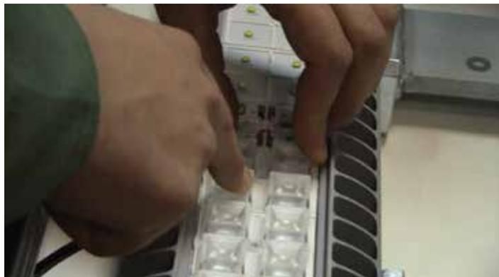
4 Установка вторичной оптики (LEDIL). Опытные работы в лаборатории ГК Остек
