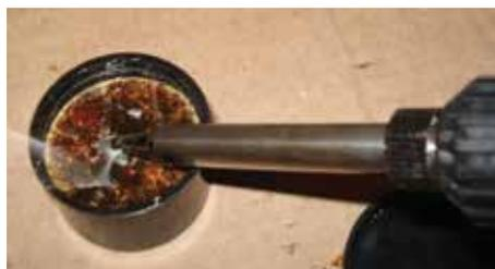
1 Медный наконечник очищается от окислов при помощи твердой канифоли
