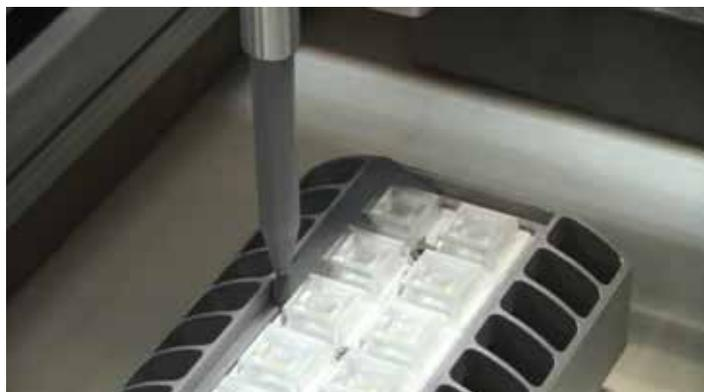
5 Заливка светильника двухкомпонентным компаундом Dow Corning. Опытные работы в лаборатории ГК Остек
