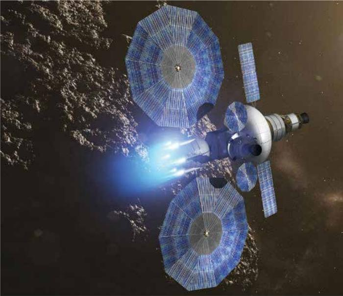
7 Американское космическое агентство NASA объявило о заключении с компанией Alliant Techsystems контракта на создание лёгких солнечных батарей с повышенной производительностью для будущих космических миссий. Прототип системы MegaFlex будет иметь мощность свыше 350 кВт при диаметре 10 метров, что в 20 раз превосходит показатели предшественников
