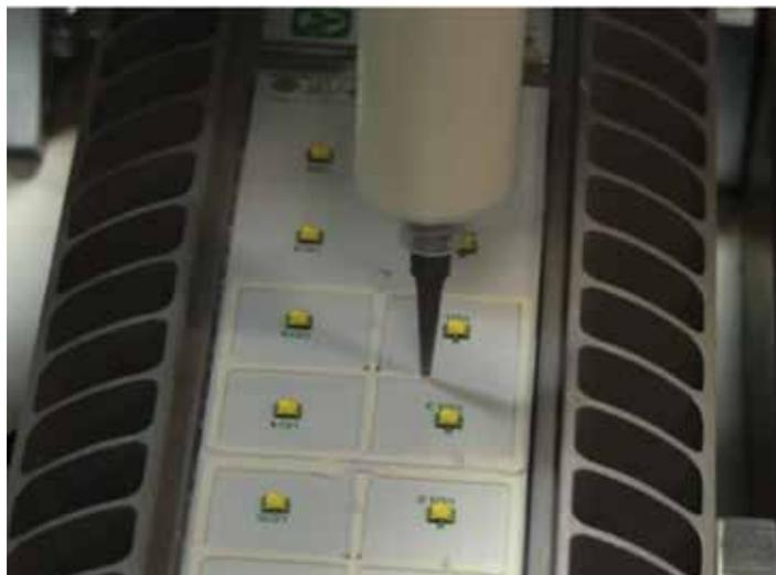
3 Нанесение силиконового клея Dow Corning для фиксации оптики. Опытные работы в лаборатории ГК Остек
