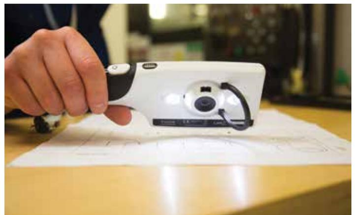
3 Откидная опора и светодиодная подсветка на системе CamZ
