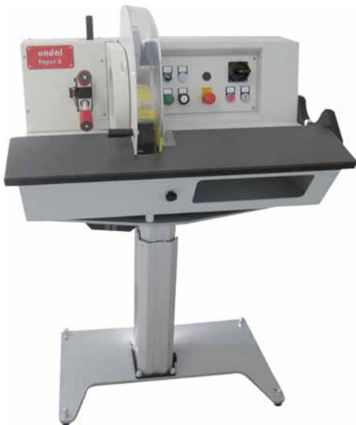
2 Полуавтоматический лентообмотчик OndaTaperS
