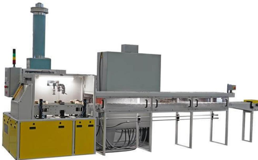
Процесс нанесения порошковой изоляции на пакет ротора:
