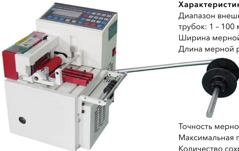
Точность мерной резки:  $0,02L + 0,2$  мм
