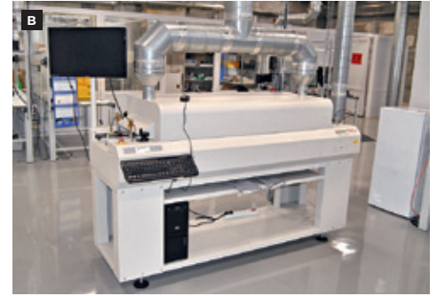
Первый комплект оборудования для поверхностного монтажа: а – система дозирования Dispence Master DD-500 (DIMA, Нидерланды); б – манипулятор Powatec (Essemtec, Швейцария); в – конвекционная печь RO300FC с тремя зонами нагрева и одной зоной охлаждения (Essemtec)
