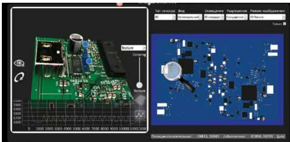
8 Работа с 3D изображением участка печатного узла. Измерение высоты галтелей
