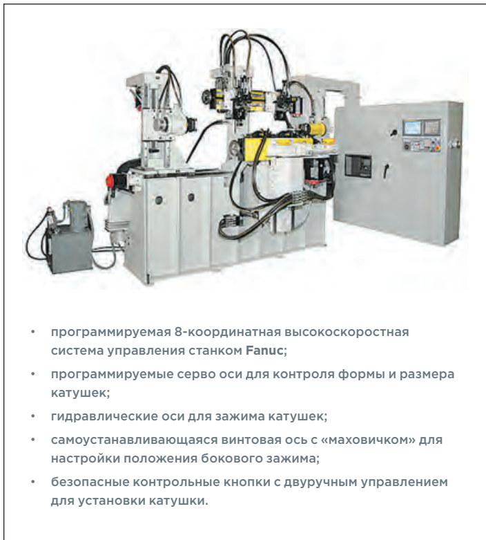
Станок для формирования катушек
