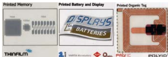
Рис. 6 Органические компоненты (память, дисплей и батарея, РЧИД-метка)
