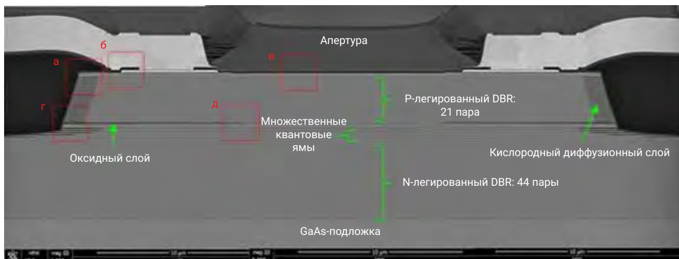
Рисунок 2. Изображение поперечного разреза VCSEL, описываемого в данной статье, полученное при помощи растрового электронного микроскопа
