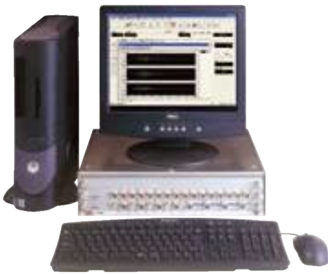
Рис. 3 Система управления механическим воздействием К2. Виды воздействий, реализуемые контроллером К2: случайная вибрация, случайная вибрация со случайным спектром, библиотека ударных профилей, виброудар, экспоненциально-затухающий удар с полисинусоидальным заполнением, синусоидальная точечная вибрация, синусоидальное качание частоты, синусоидальная вибрация со случайным спектром, определение резонанса, воспроизведение записанных профилей Производитель компания IMV Corp., Япония Номер в Государственном реестре средств измерений 36717-08 от 17 января 2008 года
