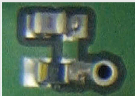
Близость переходного отверстия к контактной площадке
