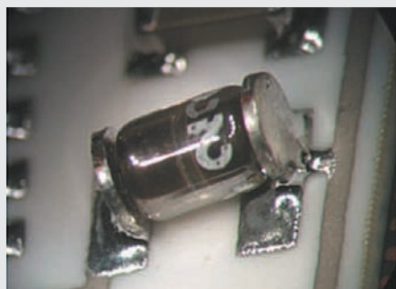
Близкое расположение дорожки к площадке
