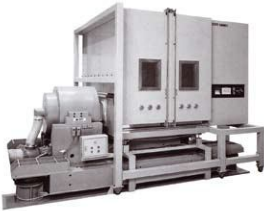
Рис. 7 Комбинированная испытательная установка. В состав входят двух координатная испытательная установка и климатическая камера. Производитель – компания IMV Corp.,
