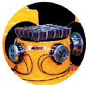
Рис. 6 Установка трехосной одновременной вибрации TS-3000-4H японской автомобильной техники. Диапазон частот от 5 до 2000 Гц. Высокочастотный подшипниковый узел «увязки» трехосного механического
