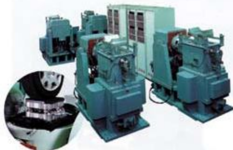
Рис. 5 Четырехопорная установка имитации дорожного профиля. Каждое колесо автомобиля подвергается воздействию двух или трехосной вибрации. 12 электродинамических вибростендов воспроизводят запись механического профиля непрерывно в течение 12 000 часов. Производитель – компания IMV Corp., Япония
