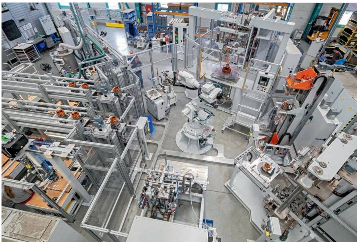
Общий вид автоматизированной линии изготовления статоров
