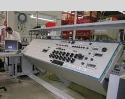
Рис. 5 Стенд контроля жгутовых соединений энергетических агрегатов
