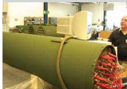
Рис. 4 Тестирование электрических цепей пусковой установки НУРС (неуправляемых реактивных снарядов)
