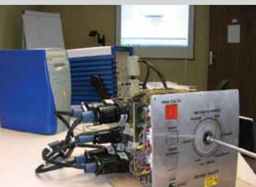
Рис. 6 Настольный тестовый комплекс контроля блока управления (железнодорожный транспорт)
