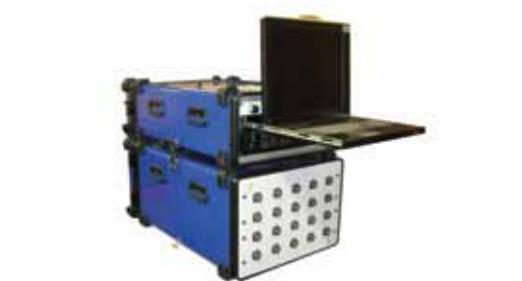
Рис. 7 Мобильный тестовый комплекс для контроля изделий спецтехники (проверка цепей безопасности перед загрузкой торпеды на ПЛ)
