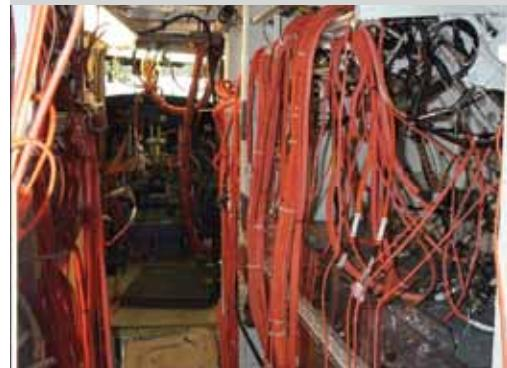
Рис. 1 Тестирование кабельной системы самолета перед монтажом авиационного оборудования. Красный цвет имеют тестовые кабели, подключаемые к внутренней проводке самолета
