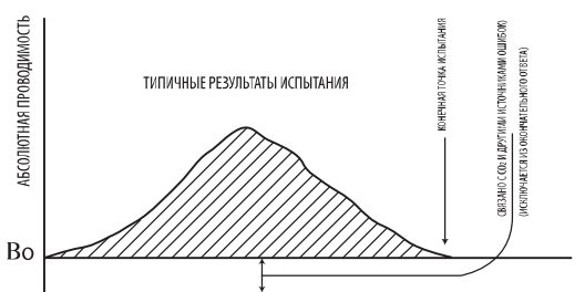
Рис. 2. Типовая диаграмма изменения проводимости раствора в тестовой ячейке установки
