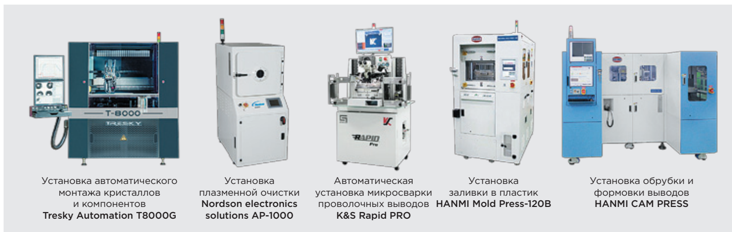
5 Линия оборудования для сборки и заливки в пластик изделий микроэлектроники
