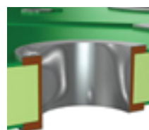
Наплывы припоя на внутренней поверхности переходного отверстия
