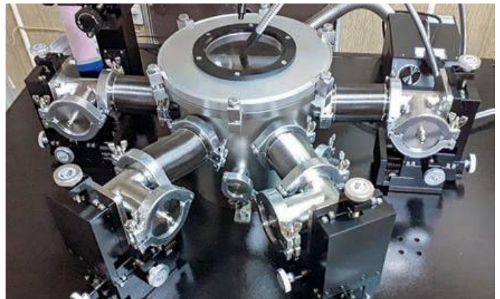
8 Расположение органов управления микроманипуляторами и триаксиальных выходов снаружи вакуумной камеры
