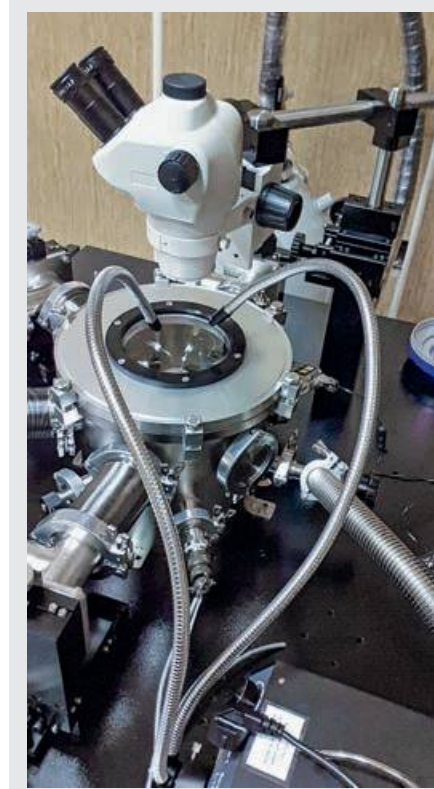
7 Расположение микроскопа и устройства подсветки над смотровым окном вакуумной камеры
