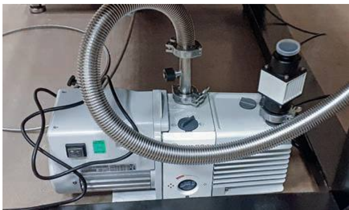
Вакуумный пластинчато-роторный насос с подсоединённым вакуумным трубопроводом и фильтром масляного тумана на выхлопе
