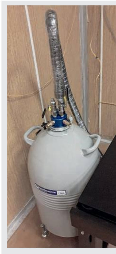
Сосуд Дьюара для жидкого азота с системой подачи жидкости в систему охлаждения
