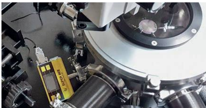
Вакуумметр, подсоединённый к одному из фланцев вакуумной камеры
