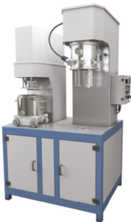
Температурный контроллер позволяет поддерживать температуру от 5 до 200 °С. В качестве нагревающих (охлаждающих) жидкостей используются: вода (от 5 до 90 °С) и высокотемпературное техническое масло (при температурах от 90 до 200 °С). Конструкция машины обеспечивает простой доступ к рабочим поверхностям миксера для облегчения процесса очистки. Резервуар установлен на платформе, которая легко передвигается по рабочей поверхности благодаря рельсовой системе.
