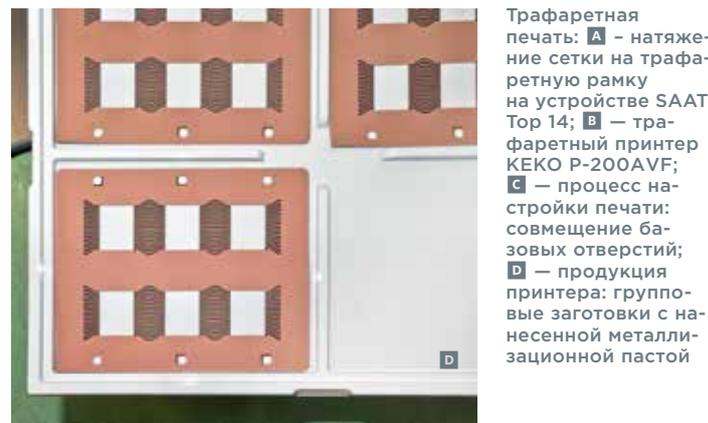
Трафаретная печать: **A** – натяжение сетки на трафаретную рамку на устройстве SAATI Top 14; **B** – трафаретный принтер КЕКО Р-200AVF; **C** – процесс настройки печати: совмещение базовых отверстий; **D** – продукция принтера: групповые заготовки с нанесенной металлизационной пастой
