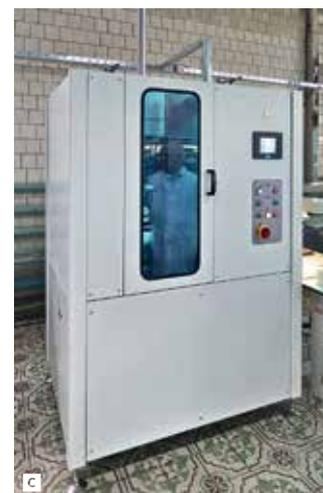
Последние операции перед разделением групповой заготовки: **А** – рабочее место комплектования пакета карт (идет сборка пакета сдвоенной заготовки корпусов с глубоким колодцем для ФПЗС); **В** – упаковка пакета карт в герметичную оболочку с откачкой из нее воздуха; **С** – изостатический пресс КЕКО ILS-66, в котором производится ламинирование (замоноличивание) пакета
