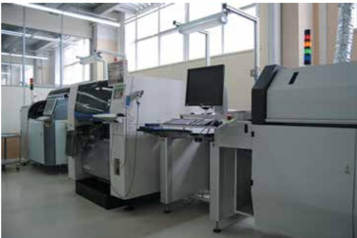
Автоматизированная линия поверхностного монтажа
