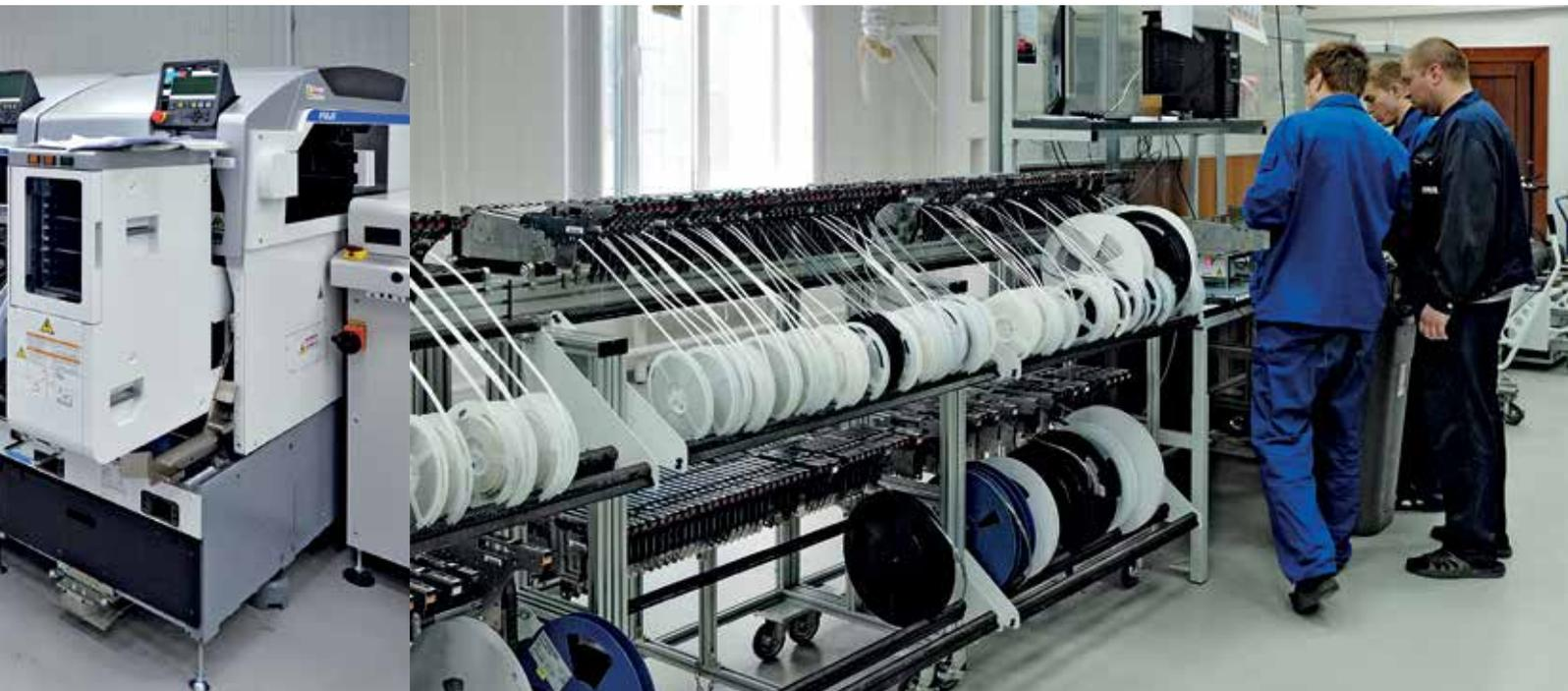
достаточно стандартна. Платы помещаются в магазинный загрузчик (компании Nutek), из него подаются в трафаретный принтер DEK Horizon 031X. И тут — первая особенность: после принтера установлен автомат оптической инспекции Viscom S3088 SPI, контролирующей точность нанесения пасты. Мы не стали использовать трафаретный принтер со встроенным модулем оптической инспекции, так как он работает медленнее, чем два независимых устройства.
