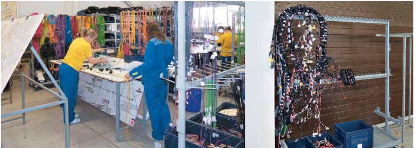
Опытно-промышленный участок. Жгут (справа) включает порядка 900 проводов
