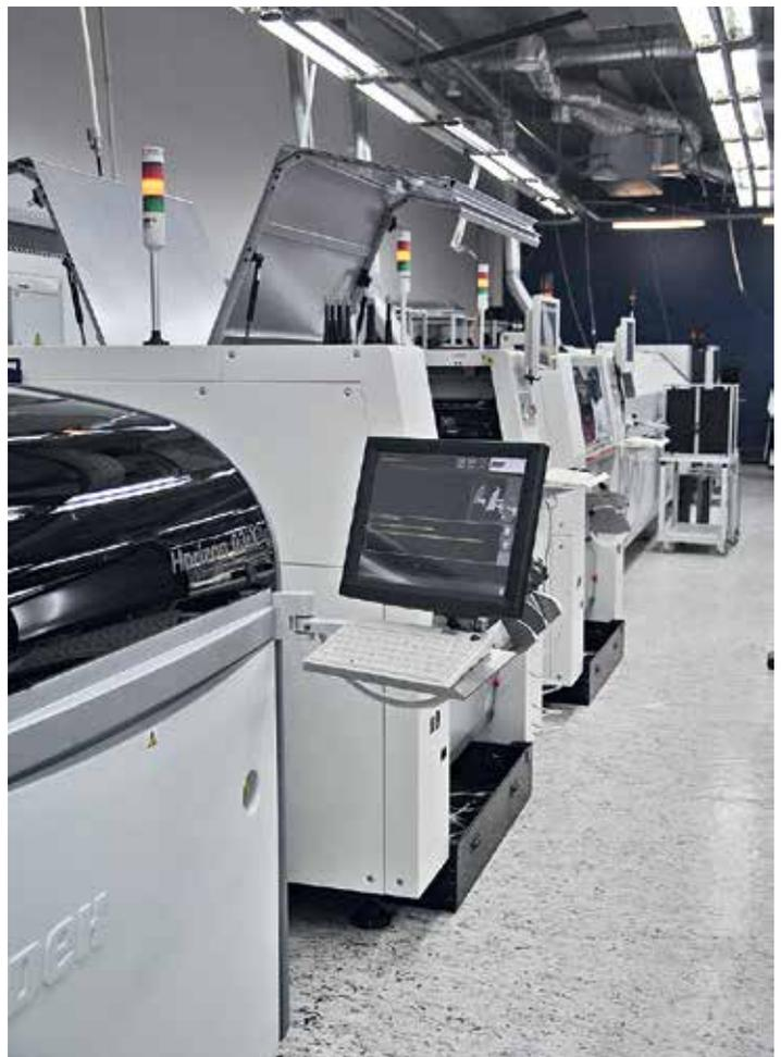
Автоматическая линия поверхностного монтажа в цехе компании «ПСБ технологии»
