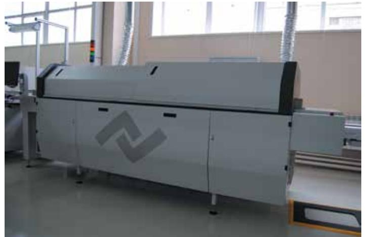
Конвекционная конвейерная печь ERSA Hotflow 2/12/08
