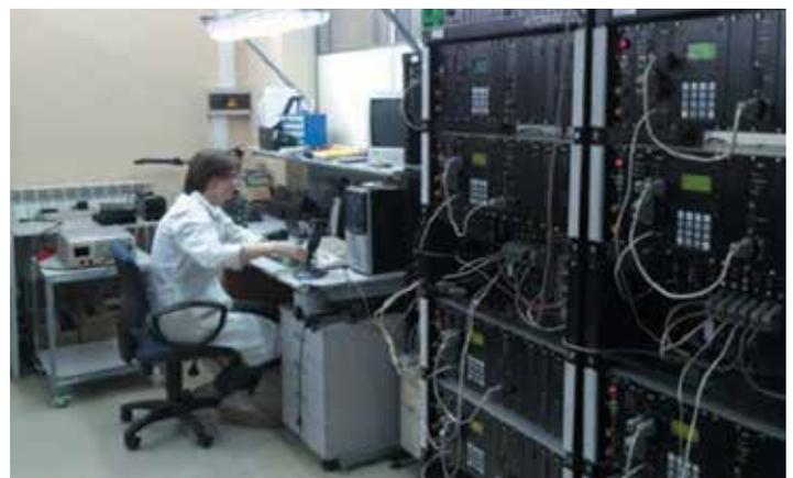
Стенды тестирования и технологического прогона продукции
