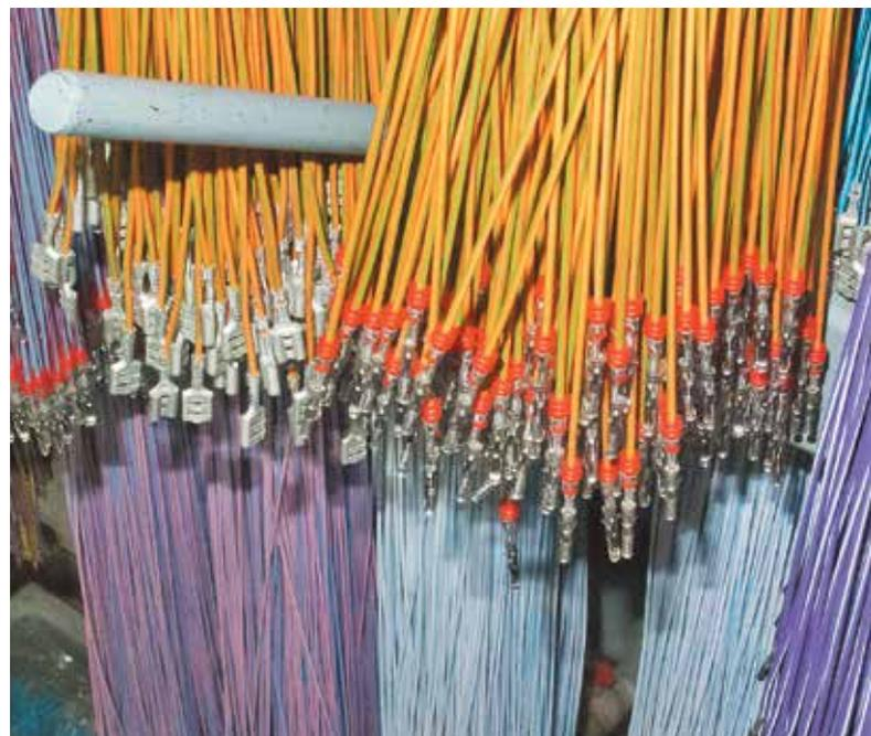
Провода с обжатыми наконечниками и уплотнителями
