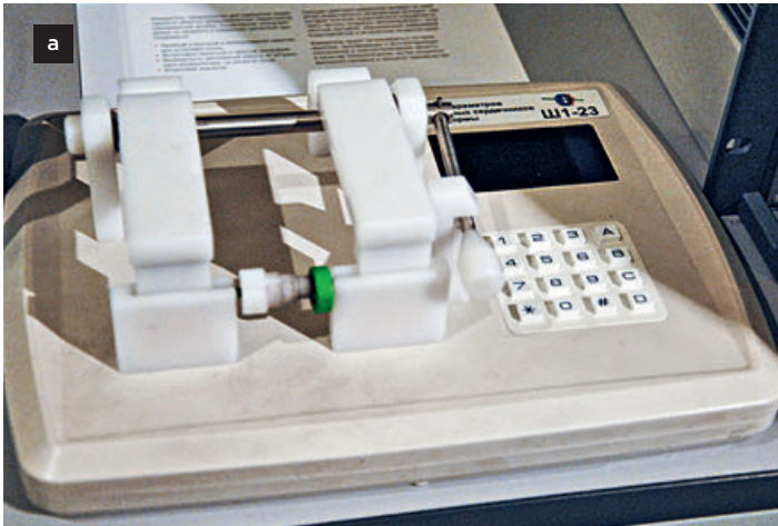
Разработано по собственной инициативе: а – измеритель параметров ферритовых сердечников кольцевой формы Ш1-23; б – генератор испытательных импульсов ИИ-33
