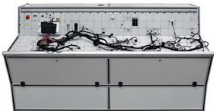
Стенд электрического контроля жгутов Emder
